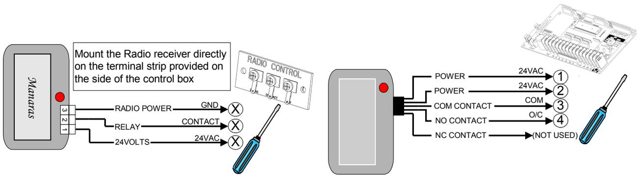
Figure 36 - RADIO 014 or RADIO 015
